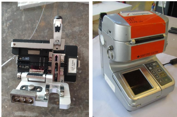
Figura 4 - Cleaver Fujikura (a sinistra) e Splicer Livingston (a destra)
