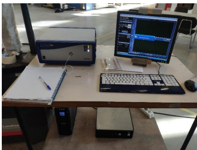
Figura 2 - Centralina di acquisizione Luna OBR 4413
