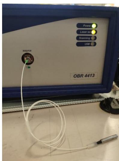
Figura 5 - Specchio Faraday per la calibrazione dell'interrogatore
