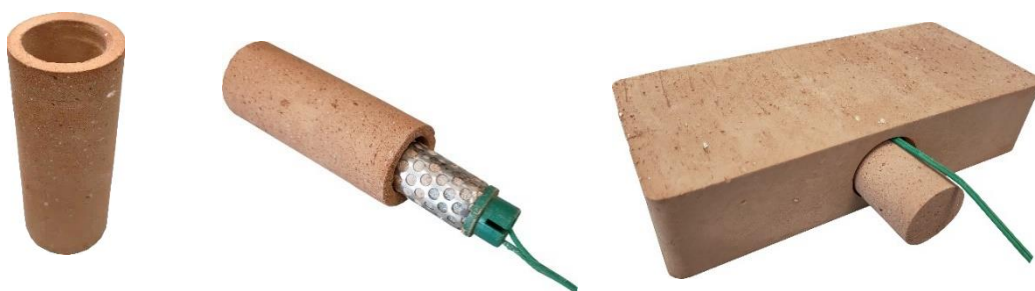
Fig. 4: nell'ordine, partendo da sinistra, cilindro in laterizio RDB (4 cm di diametro e 10 cm di altezza) in cui viene inserito il sensore Watermark. Successivamente, il ceramico sensorizzato viene inserito in un mattone appositamente carotato, con la parte forata rivolta verso l'interno.
