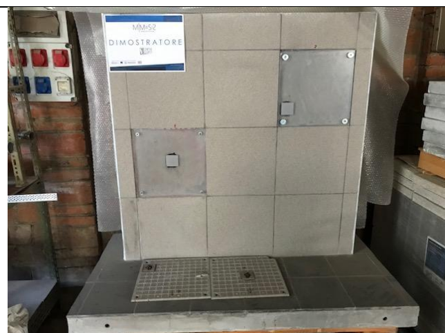
Fig.3: prototipo (lato interno) con testa di misura dei sensori visibile a parete montati su due lastre di plexiglass trasparente
